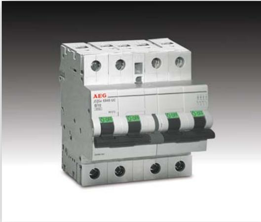
Per impieghi in DC, AEG propone, all'interno della serie degli interruttori modulari Elfa, una esecuzione speciale, la serie E90SUC. Gli interruttori di questa serie possono essere utilizzati per tensioni continue nell'esecuzione unipolare fino a 250V, bipolare fino a 500V e quadripolare fino a 1000V.
